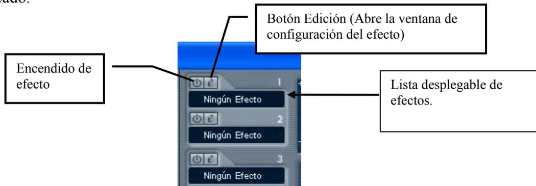
Recuerda que puedes modificar la configuración del efecto picando en el botón Edición del punto de edición deseado, y que puedes activar el By-Pass de todos los puntos de inserción desde el botón correspondiente de la pista (Vid. Supra. Pág. 8). Si quieres poner en modo by-pass tan sólo un punto de inserción puedes recurrir al botón de encendido de dicho punto.
