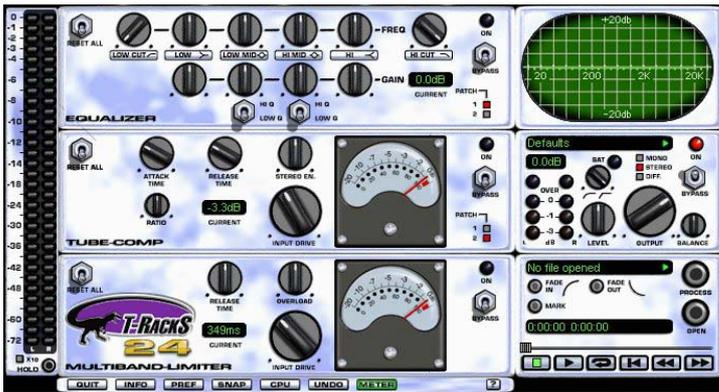
El programa se divide en diferentes módulos: Ecuación, Compresor, Limitador multi-banda, Salida y panel de control. Además incluye un vúmetro que se visualiza pican-do en el botón “meter” de la barra de herramientas inferior.
